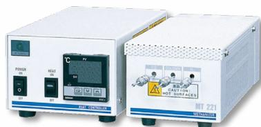
CO、CO<sub>2</sub>の微量分析はTCDでは行うことができませんが、ニッケル触媒を使用してCO、CO<sub>2</sub>をメタン化することにより、FIDで高感度分析が可能になります。MT221は接続配管で現在使用中のカラム出口とFIDの間に取り付けるだけで、CO、CO<sub>2</sub>の微量分析が可能なシステムを作ることができます。
