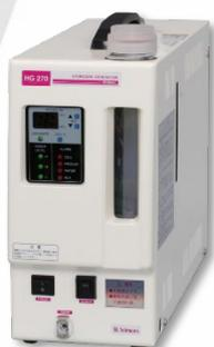
HG270 は、水の電気分解により、安全に必要な分だけ水素ガスを発生できます。ガスクロマトグラフ(FID, FPD)、炭化水素計、CO<sub>2</sub>計などの分析機器の燃料ガスや物理・化学実験用、研究用水素源として使用できます。停電などでHG270への通電が止まった場合、停電復帰時に水素ガスが自動で発生しないように安全機能を搭載し、さらに、感震器を標準装備することにより地震時に水素ガスの発生を自動停止します。今後起こり得る自然災害に対して、安全運転ができるように配慮しました。
