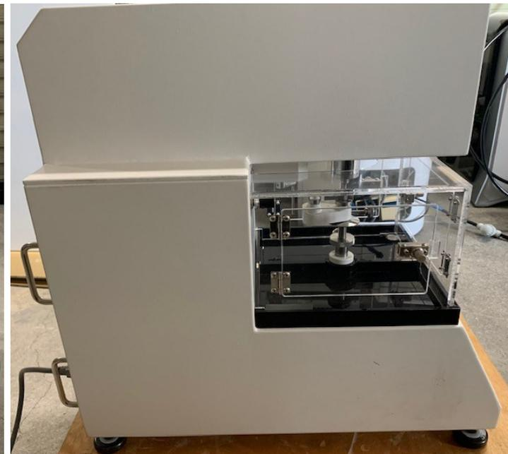
【錠剤破壊強度測定部】
