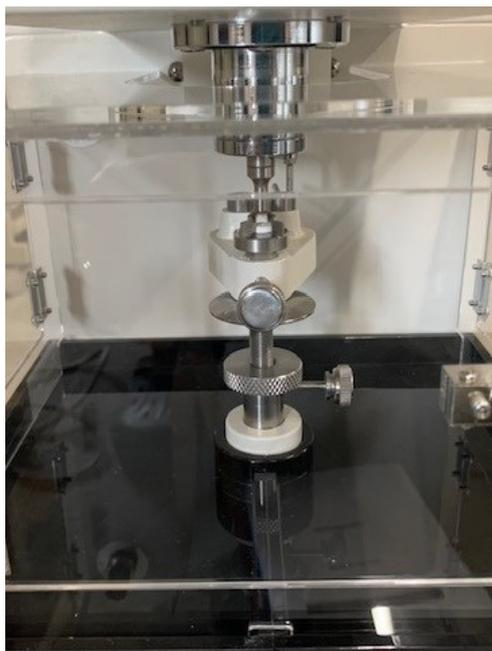
【錠剤破壊強度測定部拡大】
