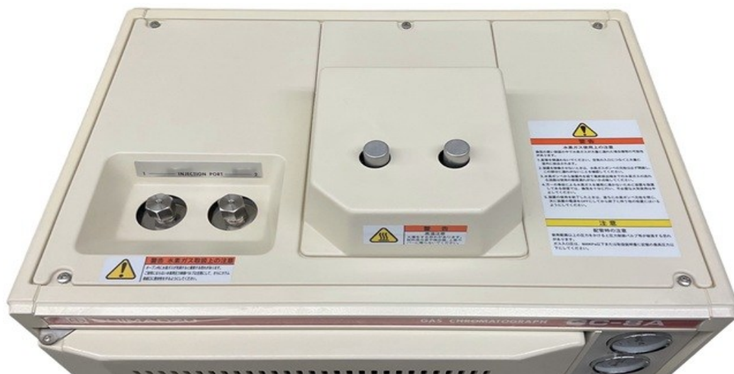
【注入口およびキャリアガス出口拡大】
