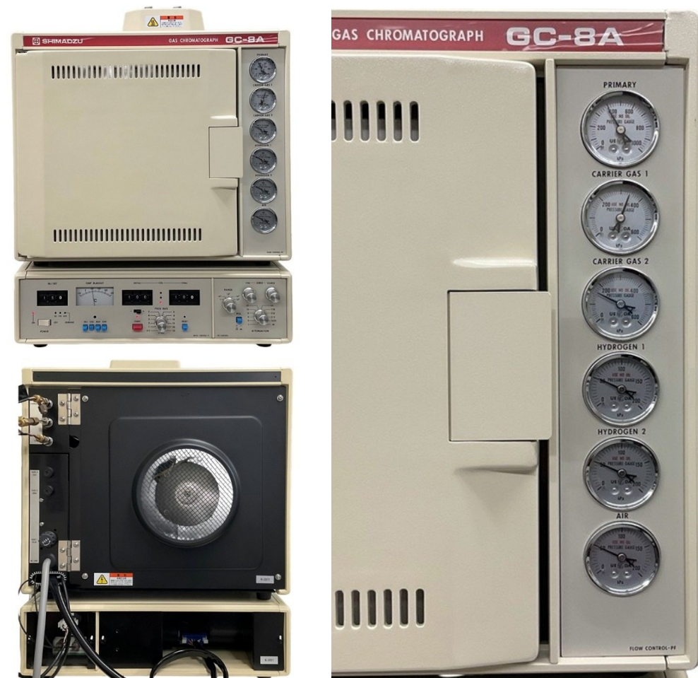
【GC装置全景,背面およびガス圧表示部拡大】
