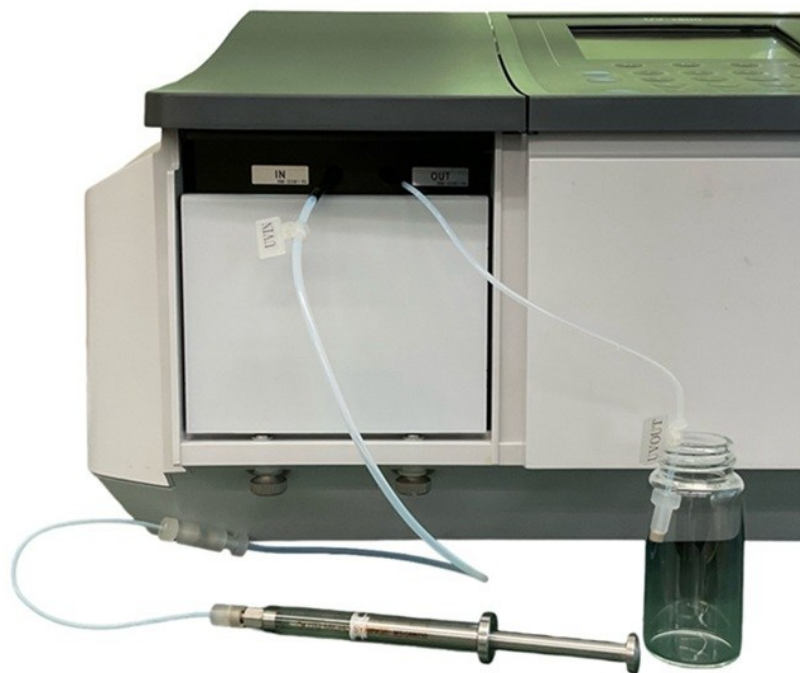
【微量セルユニット装置設置写真】
