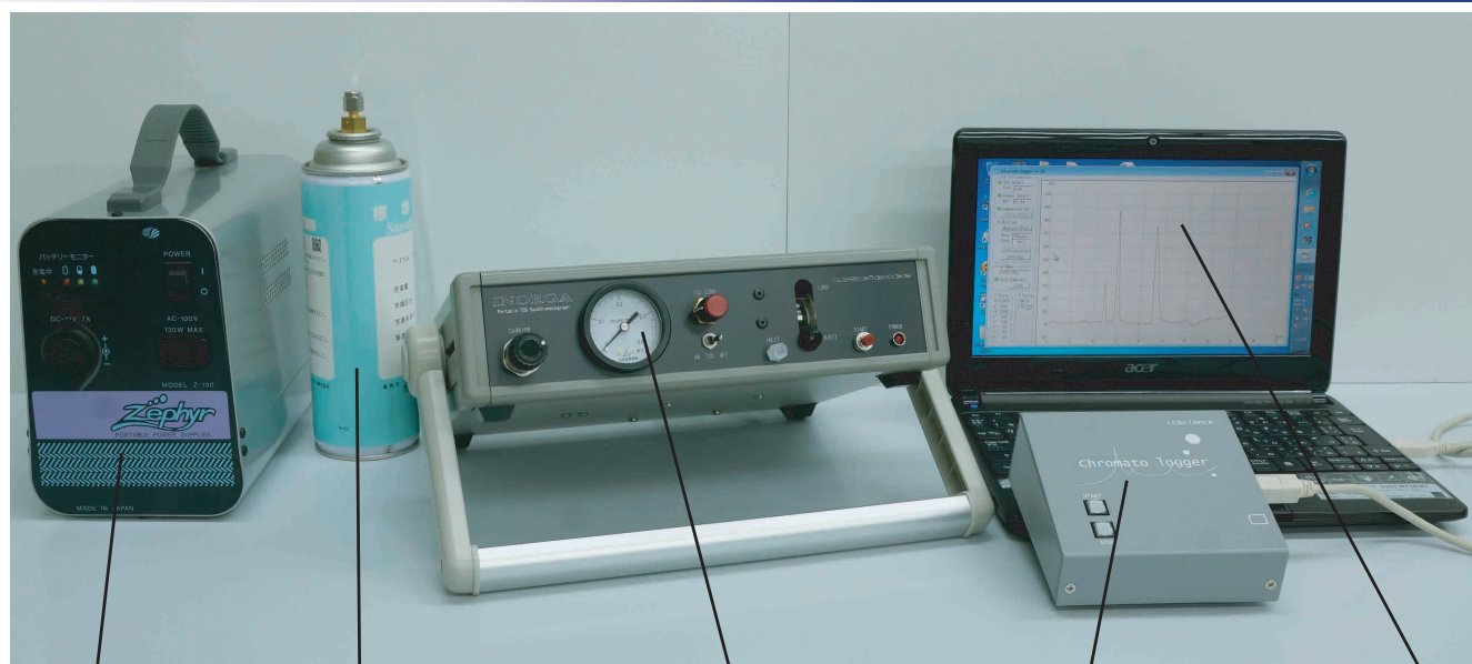
ポータブルバッテリー キャリアガスプッシュ缶 INORGA (本体) Chromato Logger パソコン (モニタリング・解析)
